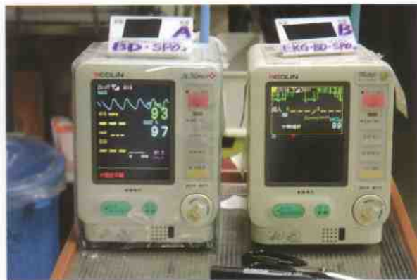
図Ⅲ51b 酸素飽和度・心拍監視装置
