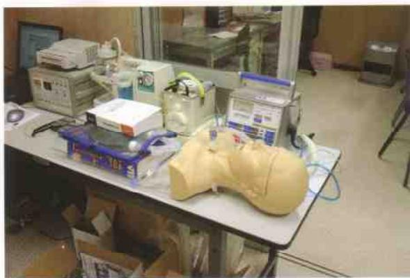
図III-51a 気管肺モデルでの24時間吸引実験
