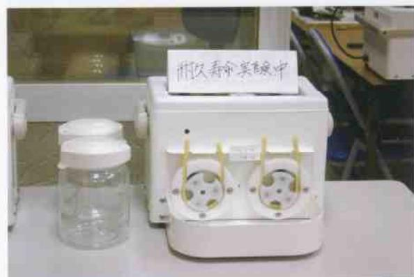
図 II-2c 自動吸引用ダブルローラーポンプ
