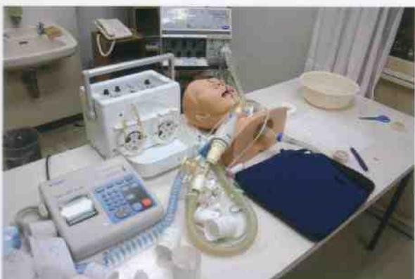
図II-2g 気管肺モデルを用いた換気損失測定実験(2005年2月)
