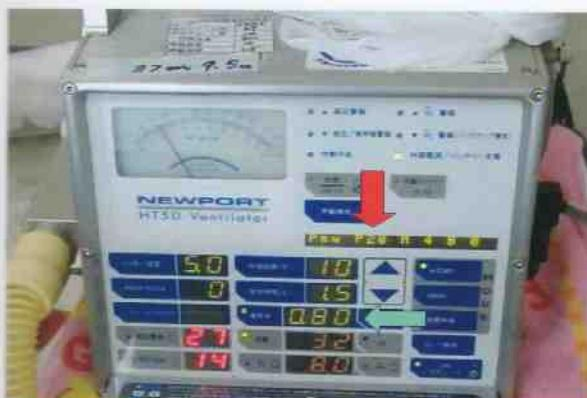
図III15a 人工呼吸器 HT50に示された通常のカニューレ使用時での最高気道内圧
