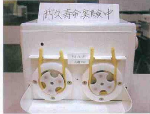
b: ローラーボンプ部、2連装されたローラーボンプと耐圧チューブを示す。在宅での長期間稼動を前提に、静音性と耐久性に心がけた。
