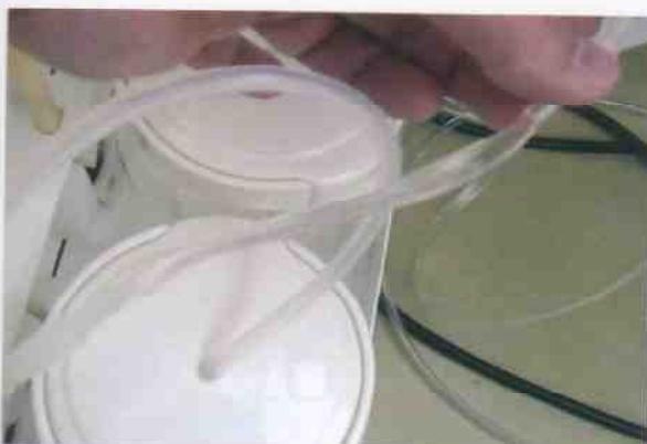
図III12c 吸引ライン閉塞による吸引ライン変形
