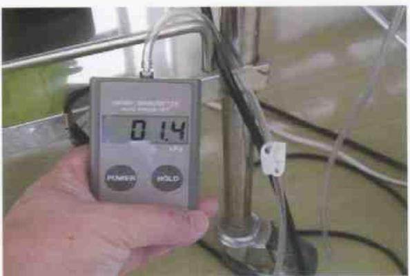
図III-12f 吸引ラインの圧力測定
